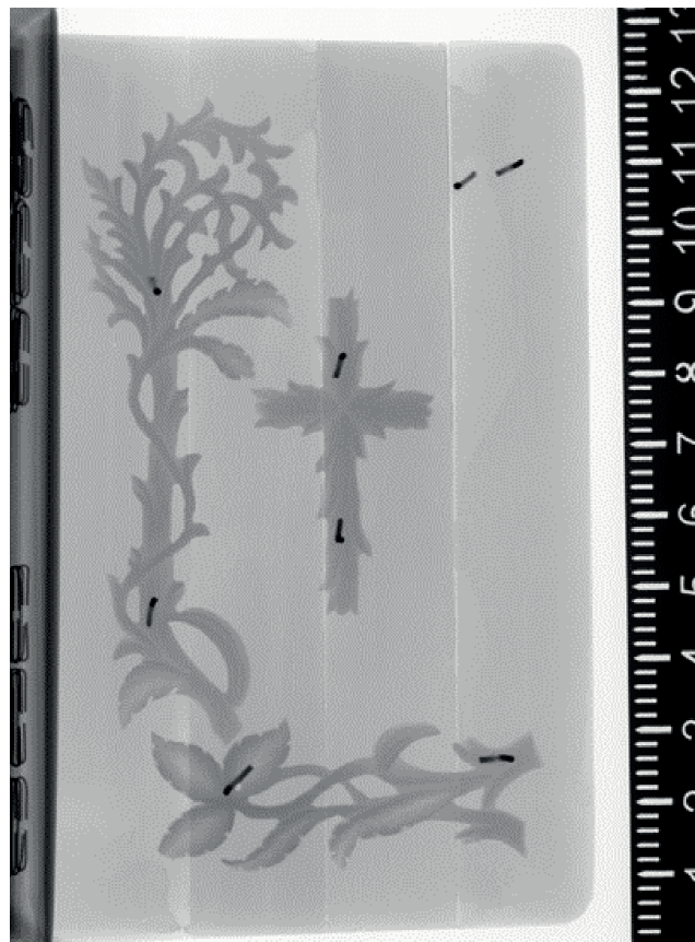
Obr. 58: Přední deska knihy Posvátní zvukové . Kniha umístěna 64 cm nad detektorem pokrytým polyesterovou fólií; rentgenka 92 cm nad detektorem; proud 300 \mu A; napětí 100 kV; citlivost detektoru 0,5 pF. Na snímku je viditelné uchycení kostěných aplikací k desce knihy, struktura destiček z kosti a lepidlo.
