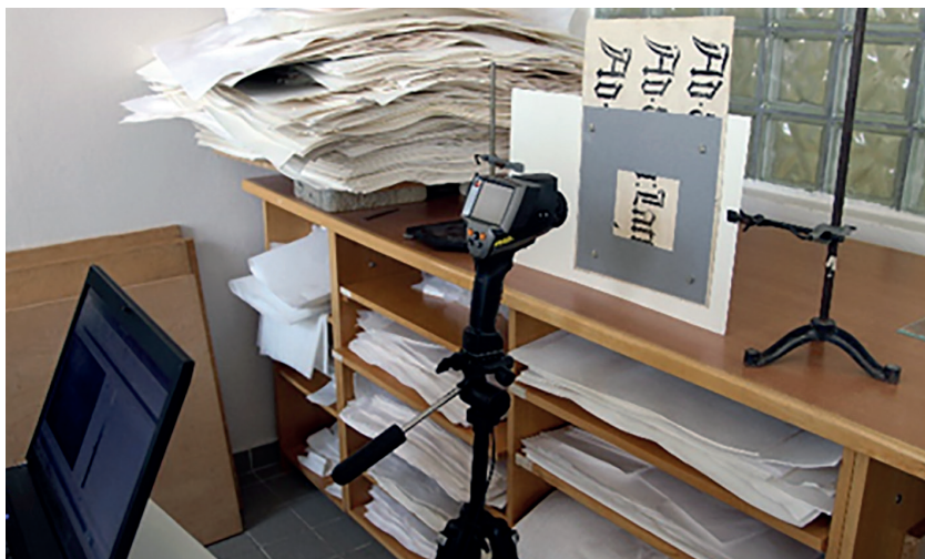
Obr. 90: Způsob uchycení dokumentu, za nějž se přibližuje nahřáté těleso, a výsledný snímek termografie.
