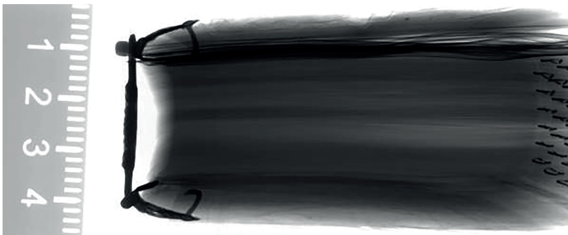
Obr. 56: Detail uchycení zapínání v desce knihy Maria královna nebeská . Kniha umístěna 64 cm nad detektorem pokrytým polyesterovou fólií; rentgenka 74 cm nad detektorem; proud 300 \mu A; napětí 120 kV; citlivost detektoru 0,25 pF. Snímek ukazuje uchycení kování v desce.
