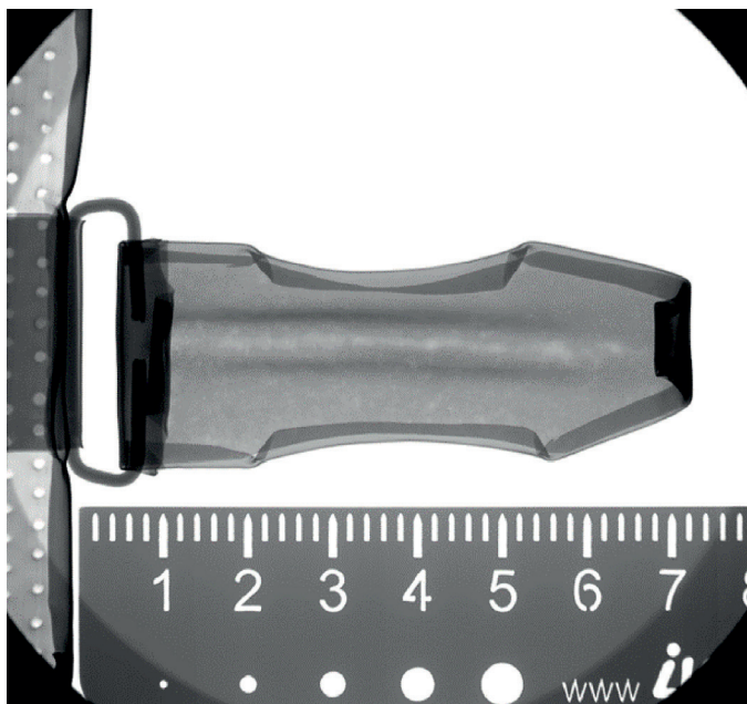
Obr. 71: Detail spony knihy Nebeklíč . Kniha umístěna 64 cm nad detektorem pokrytým polyesterovou fólií; rentgenka 79 cm nad detektorem; proud 300 \mu A; napětí 120 kV; citlivost detektoru 0,5 pF. Na snímku je vidět kování knihy. Spona zavírání má jádro asi z 3 mm silného materiálu a její pohledová strana je překryta tenkým plechem, který také pokrývá desky knihy. Na snímku jsou jasně viditelné sklady tenkého plechu přes jádro.
