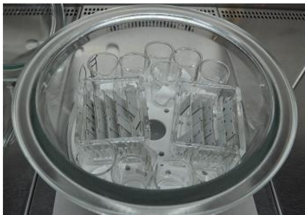
Obr. 1 Umístění vzorků spor na papírových nosičích (na filtračním papíře a lepence) v kádinkách a stojácích pro test par EO
