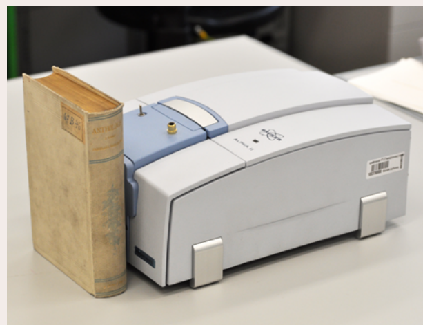
Obr. 1 Materiálová analýza pomocí FTIR spektrometru, modul externí reflexe
