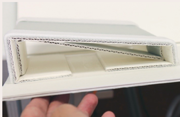
Obr. 58–59 Fotografie z procesu sestavování ochranného obalu, vpravo profil výložky vyrobené z dutinkové lepenky
