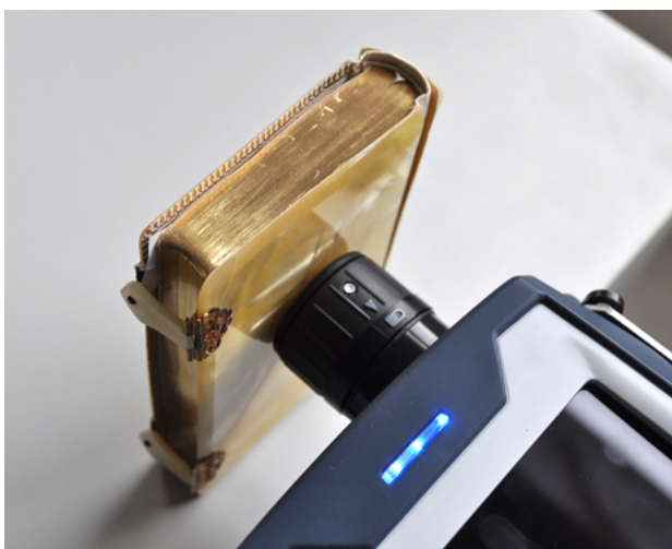
Obr. 2 Analýza povrchu desek Ramanovým spektrometrem
