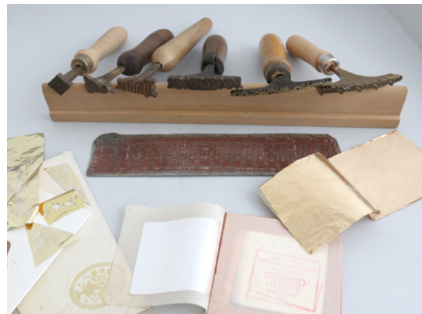
Obr. 83 Fotografie nástrojů z restaurátorské dílny v NK ČR – tlačítka, otisky, role
