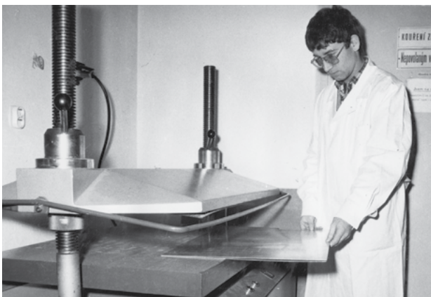
Obr. 30 Ing. Ďurovič pracuje s metodou štěpení papíru
