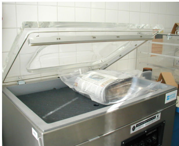
Obr. 15 Sušení knih ve vakuových balíčkách
