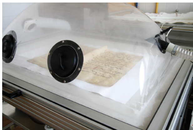
Obr. 52 Zvlhčování pergamenového folia ve zvlhčovací komoře
