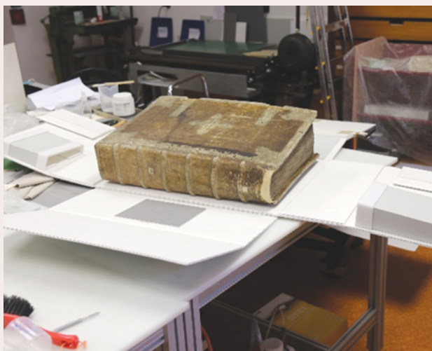
Obr. 58–59 Fotografie z procesu sestavování ochranného obalu, vpravo profil výložky vyrobené z dutinkové lepenky
