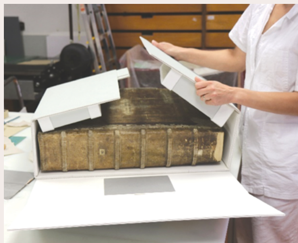
Obr. 58–59 Fotografie z procesu sestavování ochranného obalu, vpravo profil výložky vyrobené z dutinkové lepenky
