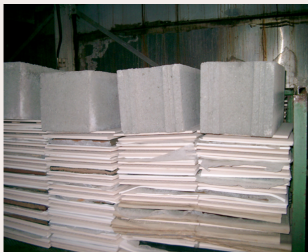
Obr. 14 Sušení knih v sušárnách dřeva v Kralupech nad Vltavou
